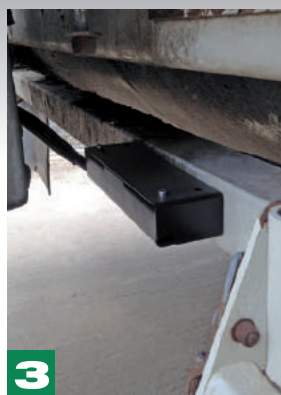
3 Układ monitorowania nachylenia pojazdu w celu zapewnienia doskonałej dokładności pomiaru w każdych warunkach.
