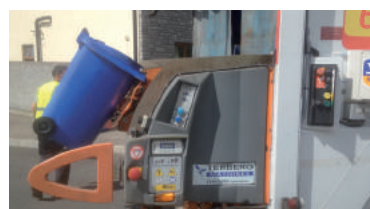
3 Układ monitorowania nachylenia pojazdu w celu zapewnienia doskonałej dokładności pomiaru w każdych warunkach.
