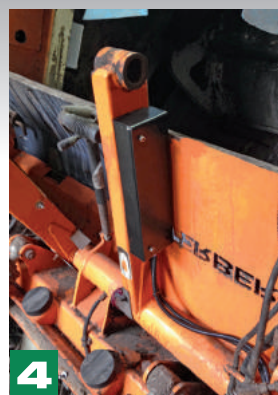
4 Monitorowanie położenia kosza podczas podnoszenia w czasie rzeczywistym.
