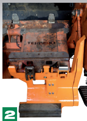
2 Mechanizm podnoszenia koszy z wbudowanym czujnikiem obciążenia i anteną RFID.
